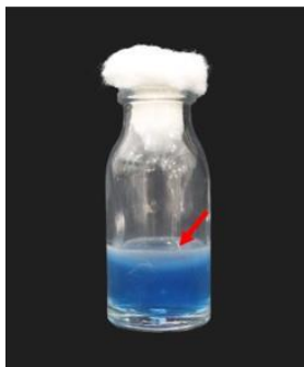
Figura 4: Demonstração do meio semi-sólido JNFb, onde a estirpe fixadora de nitrogênio foi cultivada. A película esbranquiçada que se forma na superfície do meio destaca sua habilidade de fixação biológica de nitrogênio.
