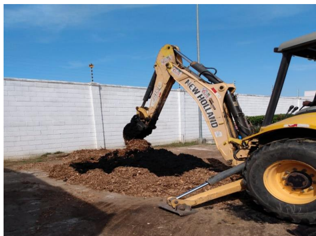
Figura 6: Montagem das leiras de compostagem
